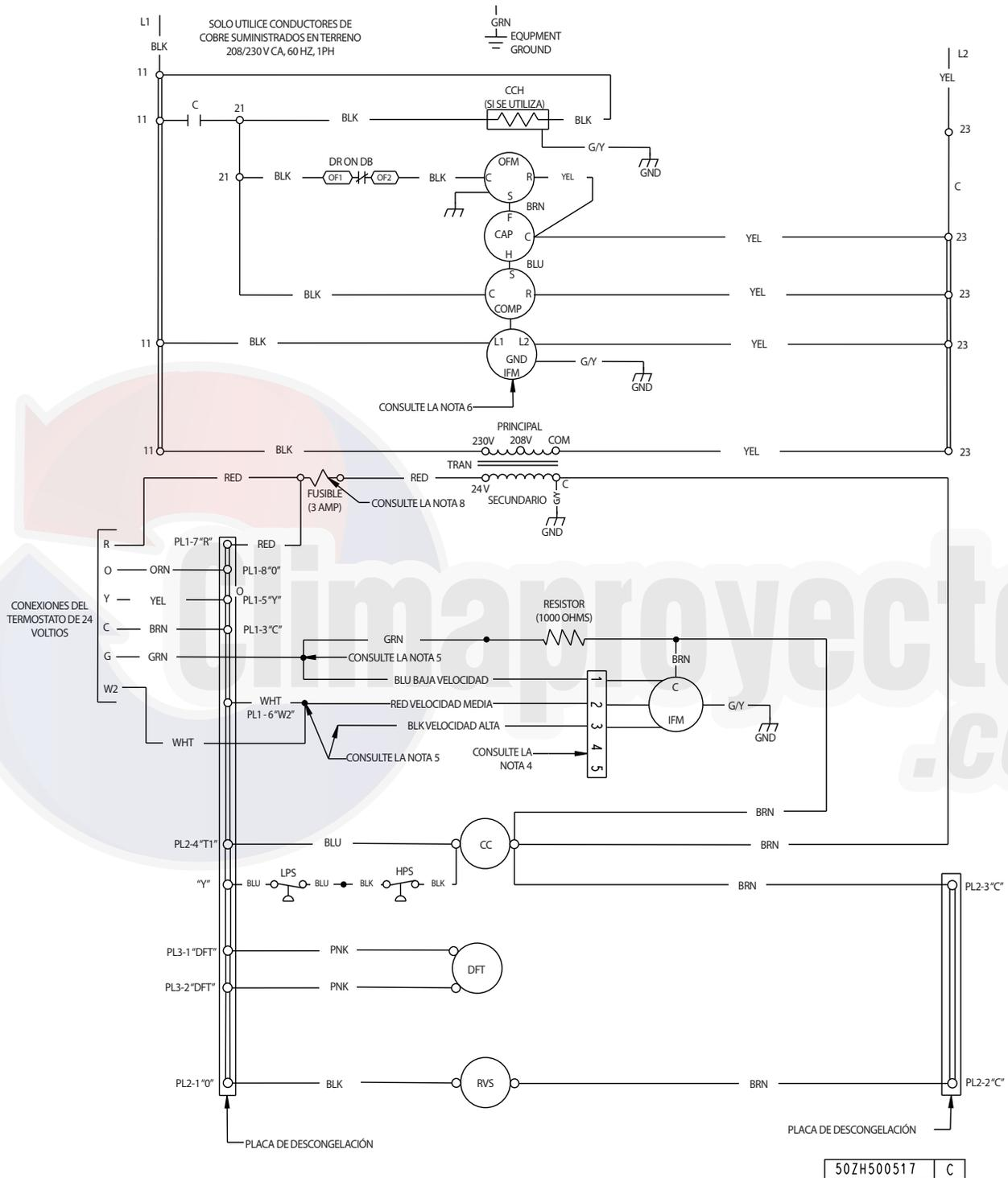
Fig. 16 – Diagrama eléctrico en escalera
