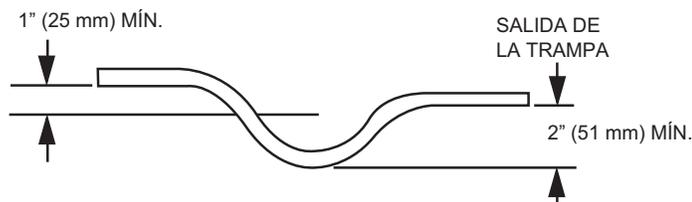
**Fig. 9 – Trampa de condensado**
