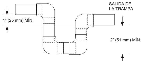
**Fig. 10 – Trampa de condensado de PVC**
