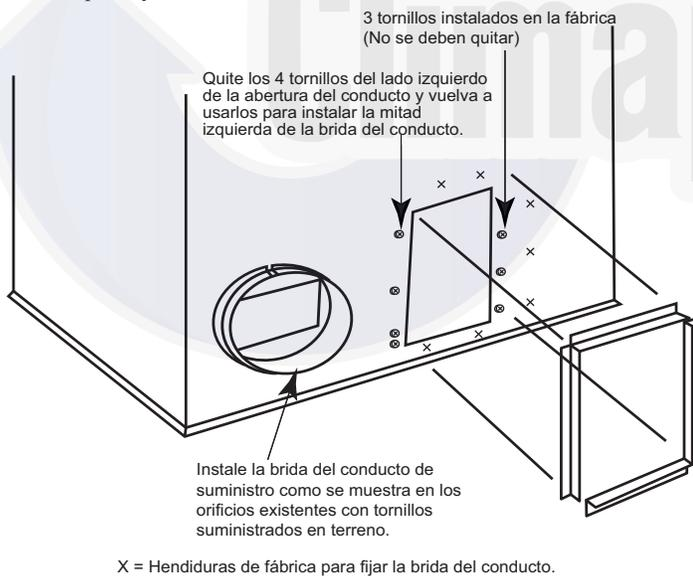
**Fig. 4 – Instalación de las bridas para los conductos suministrados de fábrica** A10081
