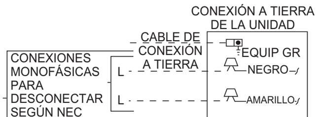
Fig. 13 – Conexiones de la línea de alimentación
