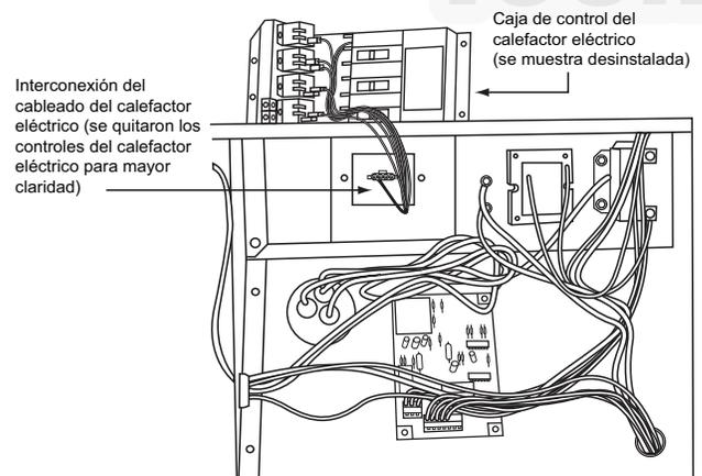
Fig. 12 – Cableado de la caja de control
