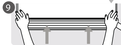
9 Monte la unidad interior
