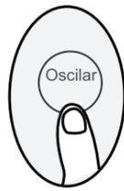
La rejilla horizontal sube y baja automáticamente al pulsar el botón Oscilar. Vuelva a pulsarlo para que se detenga.
