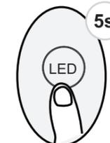
Si mantiene pulsado este botón durante más de 5 segundos, la unidad interior mostrará la temperatura ambiente real. Si vuelve a pulsarlo durante más de 5 segundos, volverá a mostrar la temperatura de ajuste (según el modelo).
