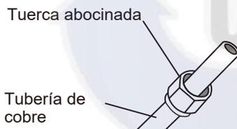
4. Quite la cinta de PVC de los extremos de la tubería cuando esté listo para realizar trabajos de abocinamiento.
