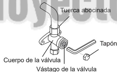
12. Utilizando una llave hexagonal, abra por completo las válvulas de alta presión y baja presión.
