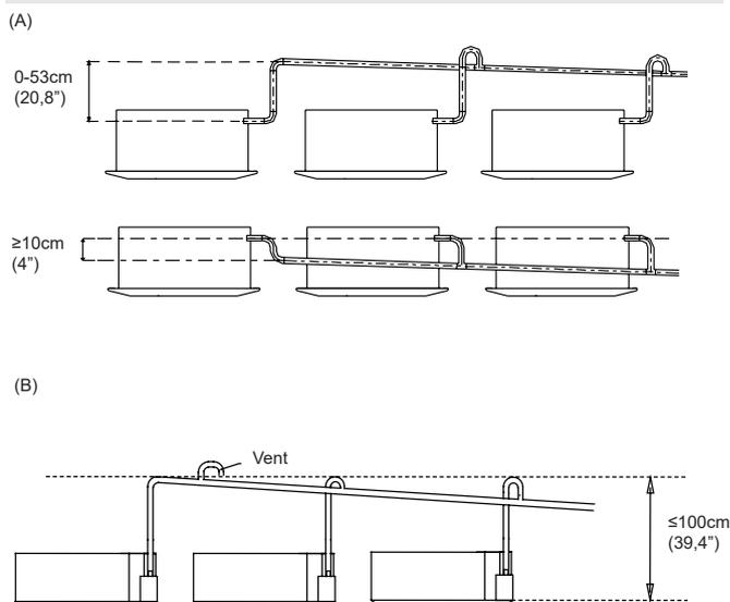
Pase la manguera de salida de agua a través del agujero de la pared. Asegúrese de que el agua se elimine hacia un lugar seguro donde no cause daños o riesgo de resbalones.
