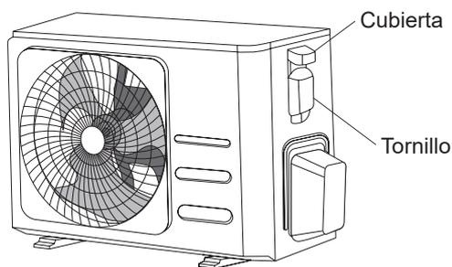
3. Conecte las lengüetas en U a los terminales. Corresponda colores/ etiquetas de cable con las etiquetas en el bloque de terminal. Atornille firmemente la lengüeta en U de cada cable a su terminal correspondiente.
