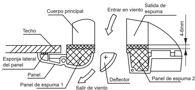
**AVISO:** Si se necesita ajustar la altura de unidad interior, puede realizarlo a través de aberturas en cuatro esquinas del panel. Asegúrese de que el ajuste no afecte el cableado interno y el tubo de drenaje.
