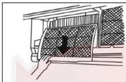
4. Si el filtro de su aire acondicionado trae un filtro pequeño refrescador de aire, desengánchelo del filtro grande. Limpie este filtro refrescador de aire usando una aspiradora de mano.
