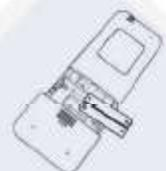
Retire las baterías del control remoto.
