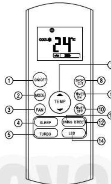
Pulse este botón con el control remoto encendido y el sistema volverá a la configuración anterior incluido el modo operativo, temperatura consigna, velocidad ventilador y la función sleep (si activada).
