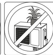
Asegúrate de que nada esté bloqueando las entradas y salidas de aire.
