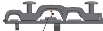
Cuando el cable no esté lo suficientemente sujeto, utiliza la hebilla para sostenerlo y así poder sujetarlo firmemente.
